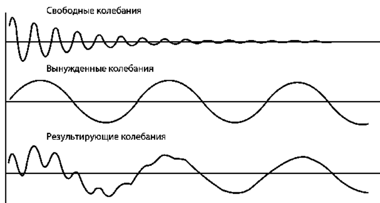
Рис. 2.1.1.2. Составляющие динамического процесса при вынужденных колебаниях линейной диссипативной динамической системы
